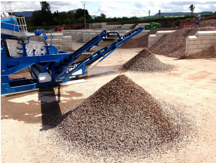
Abbildung 7: Recycling – Output-Material: sortenreines Splitt-, Kies-, Schottermaterial
