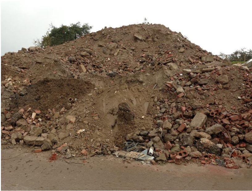
Abbildung 6: Recycling – Input-Material: Boden-Bauschuttgemisch
